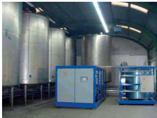
Zurigo: impianto Biodiesel MD 250: biodiesel da oli vegetali di frittura ristorazione con capacità annua di 2000 t di biodiesel di ottima qualità
